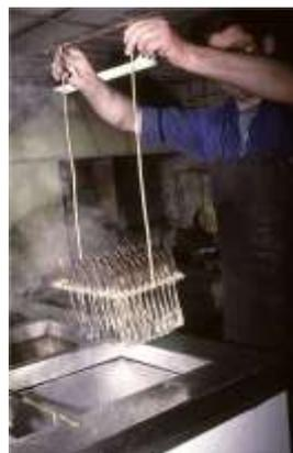
Matériel : Une cuve remplie d'une solution de sels d'argents ( $\text{Ag}^+_{(aq)}$ ), une fourchette en métal, un générateur de tension continu, une électrode en argent  $\text{Ag}_{(s)}$ .
